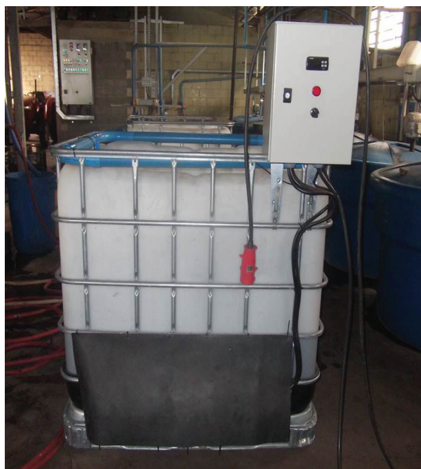
Figura 1. Protótipo utilizado como banho-maria para o tratamento dos bulbos de lírio.
